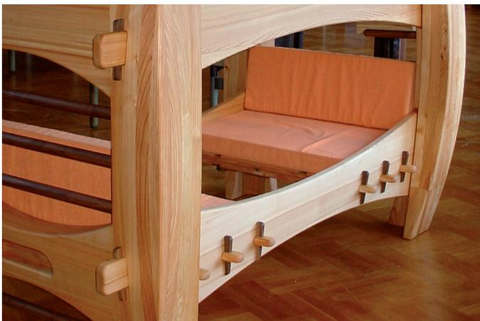
Früher wurden diese Verbindungen genutzt um Wagen, Gestelle, Gerüste– bis hin zu ganzen Gebäuden– mit Hilfe zerlegbarer Holzverbindungen flexibel einzusetzen. Heute findet man diese Flexibilität in den lösbaren Beschlägen von modernen Möbeln in großer Vielfalt wieder. Diese Verbindungen dienen dann dazu, dass Möbel leichter transportiert und hergestellt werden können.
